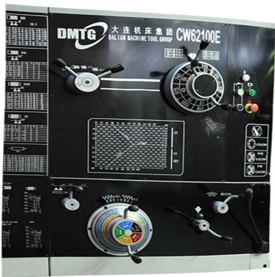
Токарный станок CW62100E, шпиндельная бабка, таблицы резьб, подачи, скоростей вращения шпинделя, органы управления
